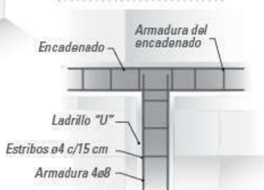
Anclaje de R.V. en encadenado Corte vertical
